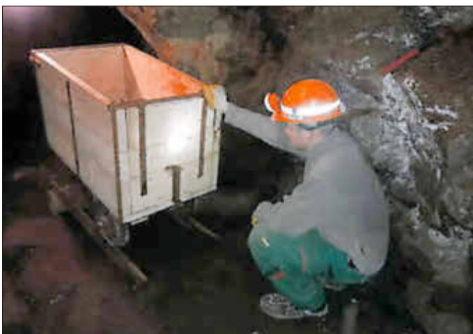
Mit solchen Grubenhunten wurde in früherer Zeit Gestein befördert.
