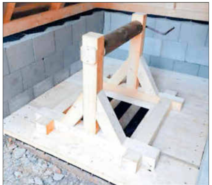
Zum bergmännischen Ensemble gehört auch eine neue Haspelkaue am „Kiesels-Hoffnung-Stolln“.
